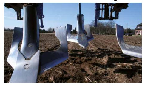
Mit dem Kompakt-Grubber Kristall von LEMKEN kann in mehreren Stufen sowohl flach als auch mitteltief gearbeitet werden. Bei flacher Bearbeitung im ersten Arbeitsgang arbeiten die speziell geformten TriMix-Flügelschare Ausfallgetreide und organische Masse ganzflächig und oberflächennah in den Boden ein. Das Ausfallgetreide verbleibt in der oberen Bodenschicht und kann kurzfristig keimen.
